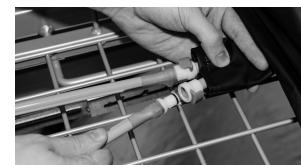
C. À l'aide des connecteurs rapides, raccordez les flexibles utilisés pour le gonflement aux flexibles des cellules d'air – « Le rouge avec le rouge » – en veillant à ce que ceux-ci ne soient ni pliés ni emmêlés.
