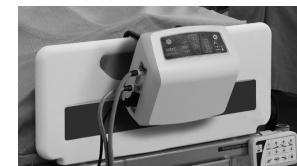
E. À l'aide des crochets du lit, suspendez le dispositif de commande sur le pied du lit.
