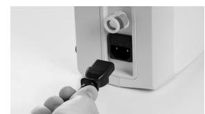
زـ. قم بتوصيل وحدة التحكم بالطاقة الرئيسية عن طريق الطاقة المتوفرة.
