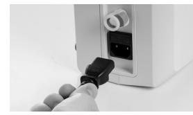
G. Conecte la unidad de control a la fuente de alimentación mediante el cable suministrado.
