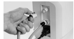
F. Verbinden Sie die Luftzufuhrscläume über die Schnellanschlüsse mit der Steuereinheit („Schwarz zu Steuereinheit“) und achten Sie darauf, dass die Schläuche nicht verdreht oder geknickt sind.
