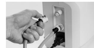
F. Met behulp van de snelsluitconnectors sluit u de luchtopblaasslangen aan op de bedieningseenheid – ‘zwart naar bedieningseenheid’ – waarbij u zorgt dat de slangen niet verdraaid of geknikt raken.
