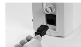
G. Schließen Sie die Steuereinheit über das mitgelieferte Kabel an das Stromnetz an.
